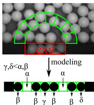
図1. ボトルネック周辺の粉体のモデル化。ボトルネック直線の領域を1次元セルオートマトンモデルで定式化する。各サイトに最大1個の粒子が入るとする。上流から確率 $\alpha$ で粒子が供給される。粒子の流出は隣接セルの状態に依存する。両隣のサイトが粒子に占められていた場合、確率 $\gamma$ で粒子が流出する。それ以外の場合、確率 $\beta$ で流出する。
